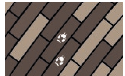
Thermoplast/ wegenverf (wit) aanbrengen op donkere tegels voor contrastwerking. Kan als laagje in de gefreesde steen.
