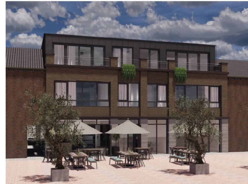
Voorstel extra verdieping en nieuwe gevelbekleding
