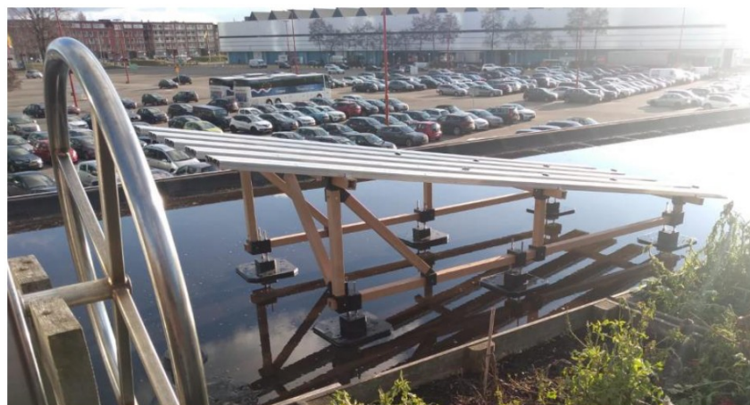
Figuur 1 - Kleinschalige proefopstelling vervaardigd uit bio-based hout-polypropyleen composiet.
