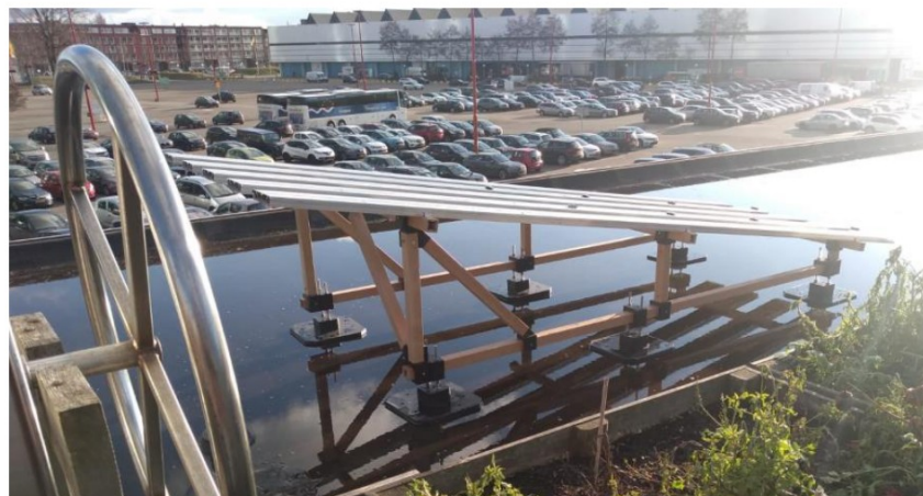
Figuur 5 - Kleinschalige proefopstelling vervaardigd uit bio-based hout-polypropyleen composiet.
