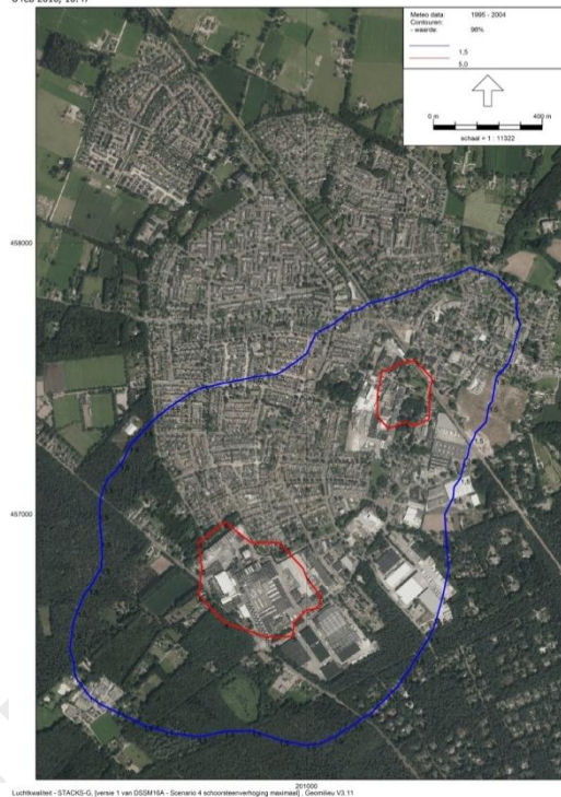
Figuur f: Contouren van 5 en 1,5 \mu\text{g}_E/\text{m}^3 als 98-percentielwaarde in de vergunde situatie met maximale schoorsteenverhoging (scenario 3).
