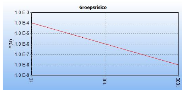
Figuur 6 FN-curve van de kilometer met de hoogste overschrijdingsfactor van gastransportleiding N-559-20 in de huidige situatie. De ligging van deze kilometer is hiernaast in het groen weergegeven op een topografische kaart.
