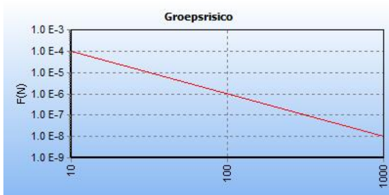
Figuur 5.6 FN curve N-559-21 van N.V. Nederlandse Gasunie voor de kilometer tussen stationing 0.00 en stationing 1000.00
